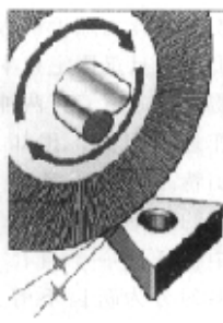
图 3 刃口的钝化半径通常在 35\mu\text{m} 到 75\mu\text{m} 之间
