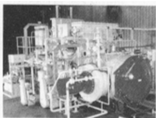
图8 三室油淬气淬真空炉 FRVOQ 型
