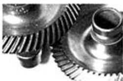
图 12 经磨粒流抛光的涡轮
