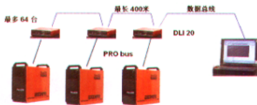
图3 计算机对弧焊设备的数据监控系统
