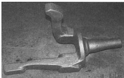
图3 我厂生产的转向节锻件
