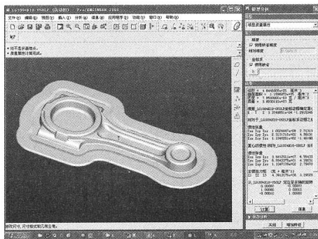
图4 连杆锻件(含飞边)的三维实体造型及重量分析
