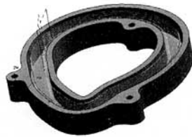
图 5 凸轮轮廓加工刀路图
