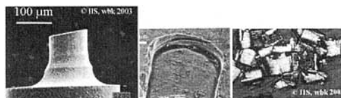
图 5 硬质合金微型铣刀及其加工形状
