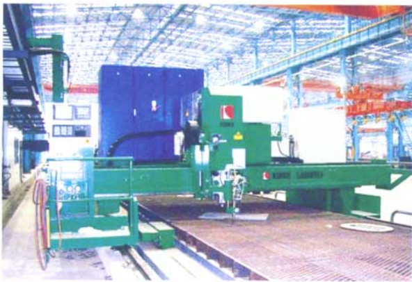
图1 江南长兴造船基地新安装的大型“搭载式”数控激光切割机 (配备德国TRUMPF 5kW CO 2 激光切割装置)
