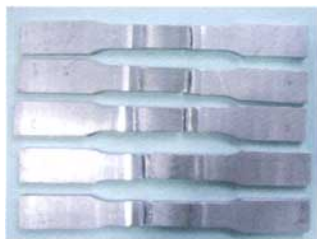
图3 5mm厚度6082铝合金拉伸及弯曲试验
