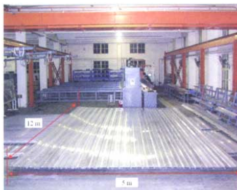
图8 赛福斯特公司制造的宽幅搅拌摩擦焊铝合金船舶壁板(60m 2 )
