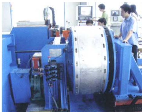
图2 无匙孔筒体结构搅拌摩擦焊接 (赛福斯特公司)
