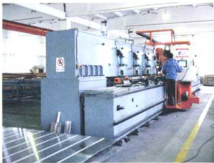
图7 中国第一台12m宽幅型材搅拌摩擦焊设备
