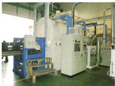
图1 双室卧式真空渗碳气冷油淬炉
