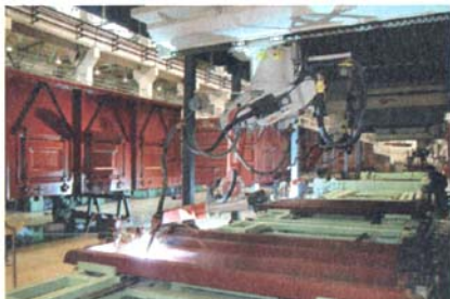
图9 焊接机器人焊接敞车端墙
