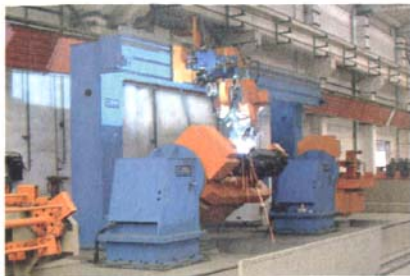
图7 焊接机器人焊接侧架支承座
