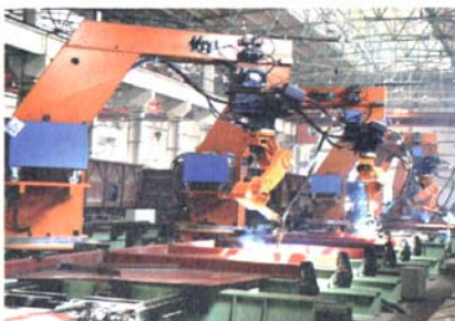
图8 焊接机器人焊接敞车侧墙
