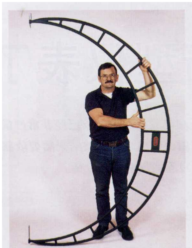
图2 Starrett公司研发的No. 724 Big Mic千分尺专门用来测量特大型零部件
