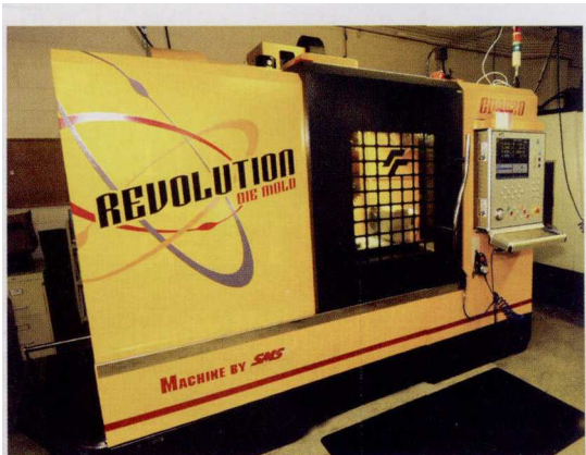
图1 这款革命性 CV4020 机床的控制器可以同时控制 8 个轴的运动，并有每秒 50 000 个字组的数据处理速度，从而保证了机床的恒速加工，因此 GBI Cincinnati 公司称该款设备至少可以缩短 50% 的加工时间
