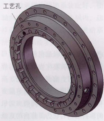
图 5 法兰部件在不影响受力的情况下增加了工艺孔,能更加有效地减轻质量和润滑各零部件
