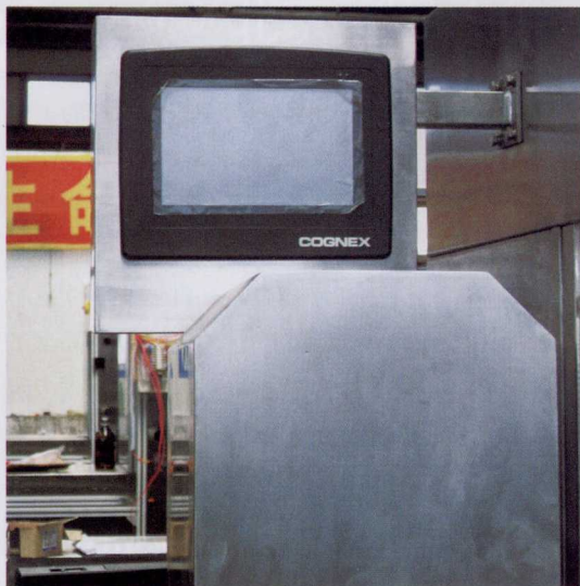
图3 从流水线上经过的药板, 是由PVC压模而成的, 由4片药板组成。在检测时, 要同时检测4板, 并且将4板分成左两板和右两板。经触发取相, 检测结果将显示在Visionview触摸屏上。系统会保存31个药板的检测结果, 然后将他们一起送至PLC, 然后控制气缸负责将坏板剔除出去
