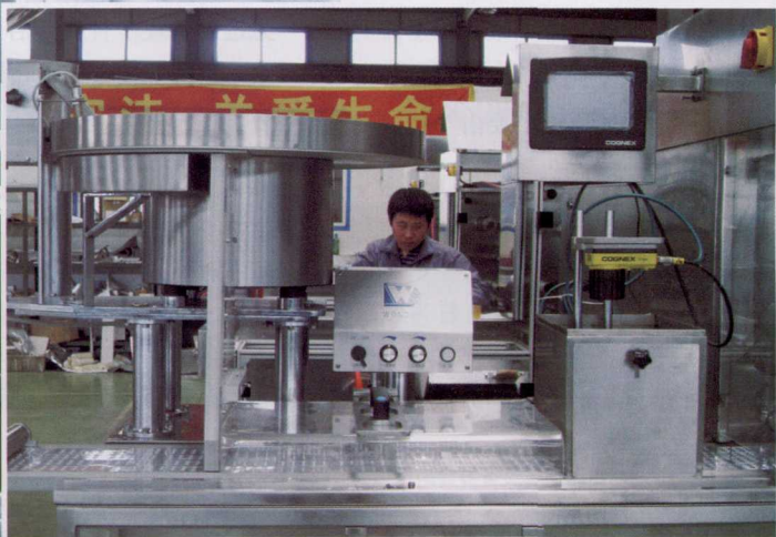
图 2 现场设备安装，相机上下可调，可调范围上下 50 mm，使 4 片药板尽量处在视野中间，并且用遮光罩将相机罩在里面，避免外界光线对图像检测产生影响
