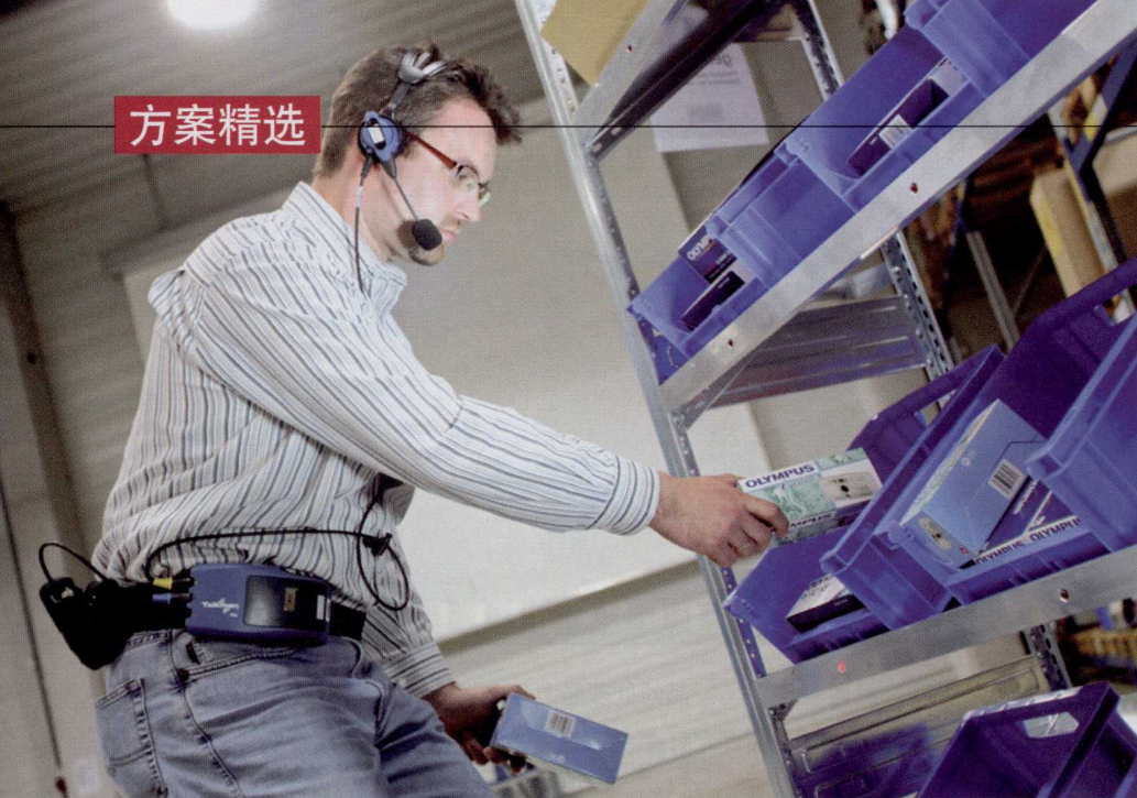
采用语音分拣的配送方式，员工无需对总体拣选清单进行一次性的传输，可以实时单独完成拣选任务
