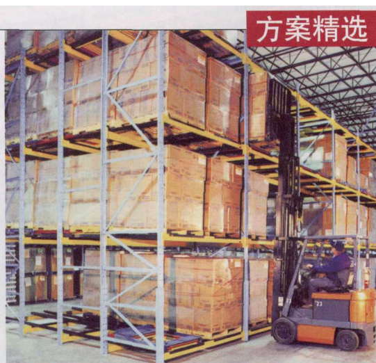
图1 当需要存储具有相同 SKU 的多个托盘时，托盘流动式货架可以帮助管理仓库
