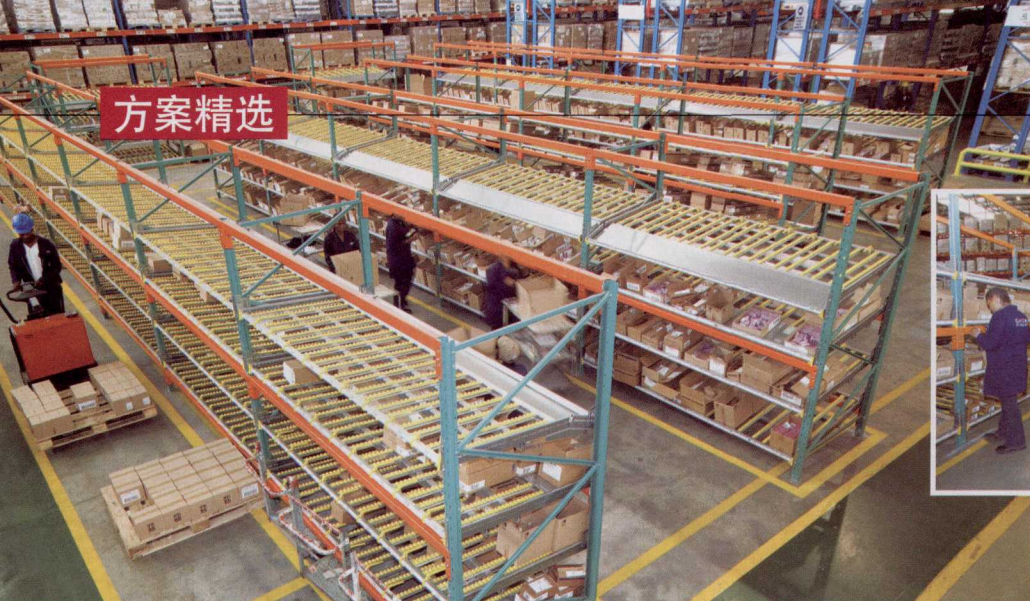
4层中的下面两层配有用于装货的进入导轨和用于卸货的终点挡板，上面两层稍微倾斜
