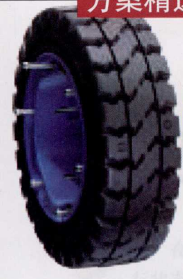
图2 Continental Tire 公司提供的 CSEasy 轮胎无需采用专用的安装设备
