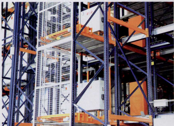
图 1 垂直运输机在任意层面上操作穿梭车系统，该系统将托盘继续运送到巷道深处
