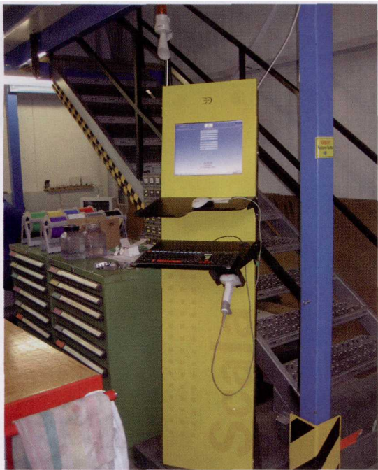
图 3 多功能支架上安装了扫描生产技术文件的条码扫描仪，以便汇总生产加工数据、为非接触的人员身份鉴别、物资运输中的 RFID 射频识别做好准备
