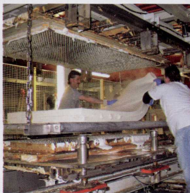
图3 能从床垫模具中取出温度约80℃的床垫坯，这是一项纯手工操作的工作。它除了要求有力气之外，还要求操作者有敏锐的感觉
