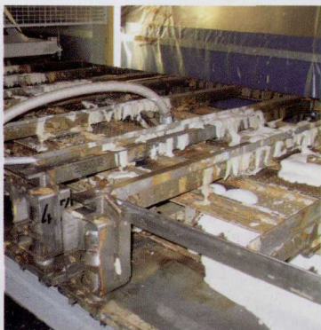
图2 在混合好的天然乳胶中加入空气形成泡沫状原材料之后，将浇注到床垫模具中
