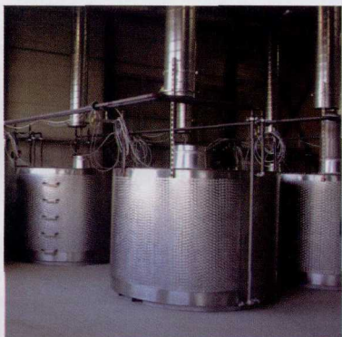
图1 天然乳胶逐步与清洁剂和硫化剂与天然乳胶混合一段时间，然后在天然化搅拌罐中搅拌均匀
