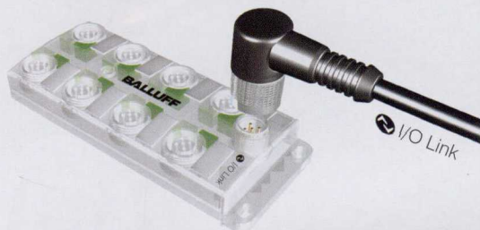
图3 Balluff 传感集线器能将开关传感器的信号收集起来，并按照不同的类型，以 8 ~ 16 个入径为一组接至 I/O Link 的连接端口
