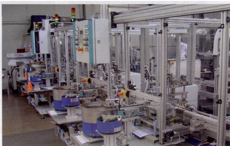
图4 安装设备的每个模块都是完全的自给自足，其拥有和各传感器及驱动器连接在一起后自身的传感集线器和控制装置
