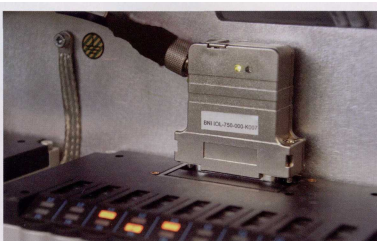
图 1 在 SMR 公司中，Balluff 的阀插头按进程将安装在上部阀岛的 8 个双阀利用 I/O Link 方式与控制层连接，靠一根经由 I/O Link 控制箱的普通三芯标准电缆，开通电源即可运行
