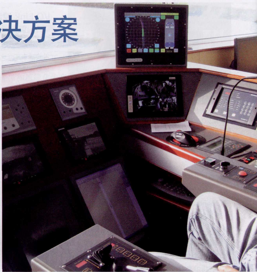
图1 用于单人驾驶船舶使用的现代化 Futura Carrier 集中控制系统
