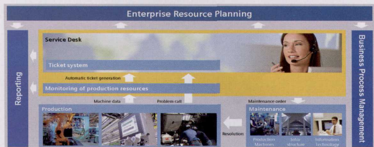
图 2 企业 IT 系统与生产管理 IT 系统都在不断地发展成长：机床设备状态接口，维护保养管理和投资回收管理等单项软件功能即使不能完全避免机床设备的故障，至少也可以及时地发现问题、快速排除故障；能够主动地管理好机床设备的维护保养费用
