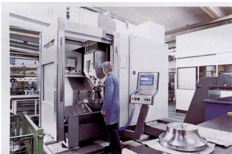
图 1 目前，已有两台 5 轴 HSC 铣削加工中心 DMC 75 V linear 在 MTU 有限公司投入使用。第三台采用新德马吉设计理念的升级版 HSC 75 linear 将续写德马吉的传奇。在控制方面，为了和 Sinumerik 840D powerline 配套，MTU 公司在引进的第三台 HSC 75 linear 上配备了 Sinumerik 840D solutionline
