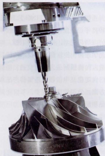
图 2 钛合金压缩机转轮的 5 轴同步加工对德马吉的 HSC 机床稳定性提出了最高要求
