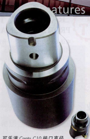
可乐满 Capto C10 接口直径为 100 mm，它大大扩展了可乐满 Capto 原来的接口系列
