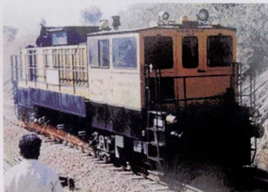
图 2 作业中的铁轨打磨车
