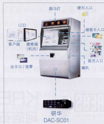
图 1 研华轨道交通 AFC 系统专用机 DAC-SC01 应用
