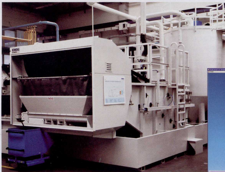
图 1 Knoll 公司生产制造的冷却液供应和过滤设备：集中控制式冷却液供应和过滤设备
