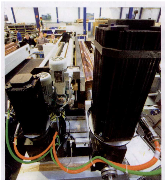
图 1 Lenze 公司提供的伺服电动机带有特殊的变速机构，印刷速度可以在 15 ~ 130 m/min 之间调节，能够为用户提供符合要求的解决方案
