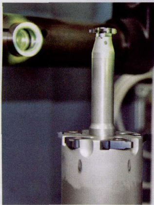
图2 这样的沟槽铣削刀具就可以加工两个不同尺寸的孔径,因此不需要更换刀具,从而减少了整体加工时间
