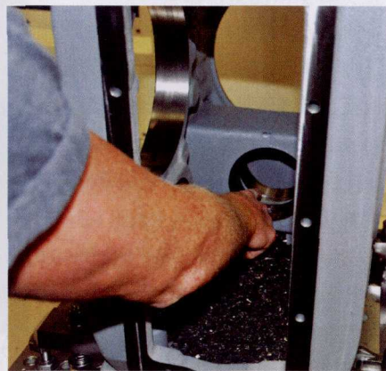
图 1 一家刀具供货商开发了一种长度为 18 in 的沟槽切削加工用刀具，其径向跳动误差仅 0.004 in。这种刀具可使齿轮箱沟槽的铣削进给速度提高 10 倍，并可深入到以往难以达到的孔深
