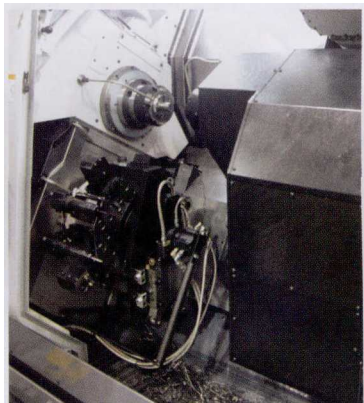
图4 副轴将工件夹住后,将其逐步拉动到加工区进行加工。从图片底部附近的转塔上可以看到一个中心固定架,它可支持工件,并可对其位置进行分度定位
