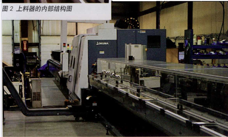
图3 该系统还包括一套下料装置,其具有足够的伸展长度以接收从另一端出来并已完成加工的零件
