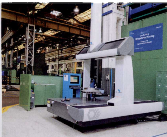
图 2 Renscan 系统实现对叶轮直径的快速扫描
