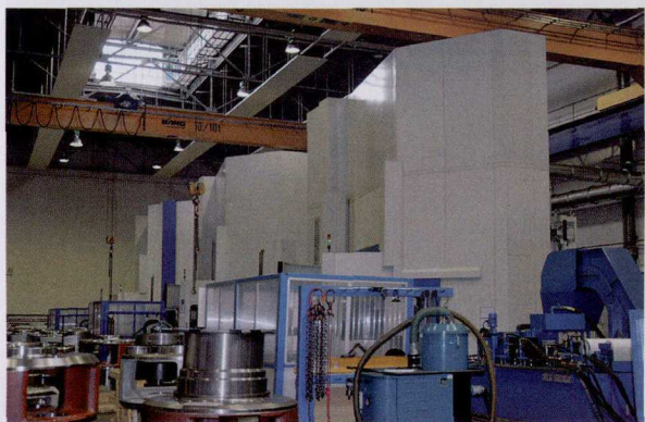
图2 在4台龙门式立车中完成行星齿轮支架的全部机械加工任务
