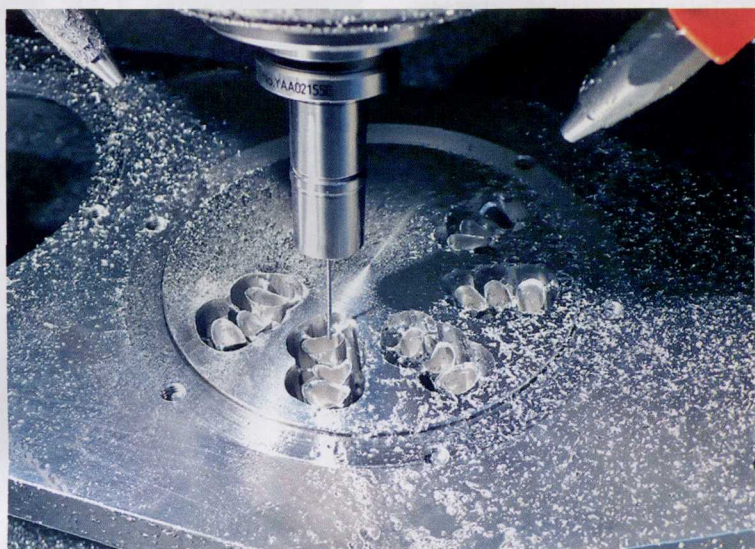
图4 费用相对较低的非铁金属合金（如钴-铬）与HSC铣削技术相结合，取代了传统的浇铸技术，从而使牙齿替代品获得很有吸引力的价格
