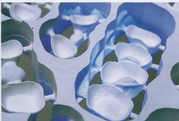
图3 绿色状态下的二氧化锆被加工成为牙齿替代品，并接受烧结处理
