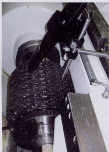
图 2 滚刀的详细情况——机床的设定
