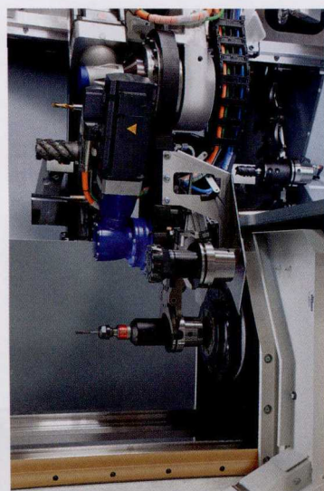
图4 一种带有双爪的刀具臂承接换刀任务
