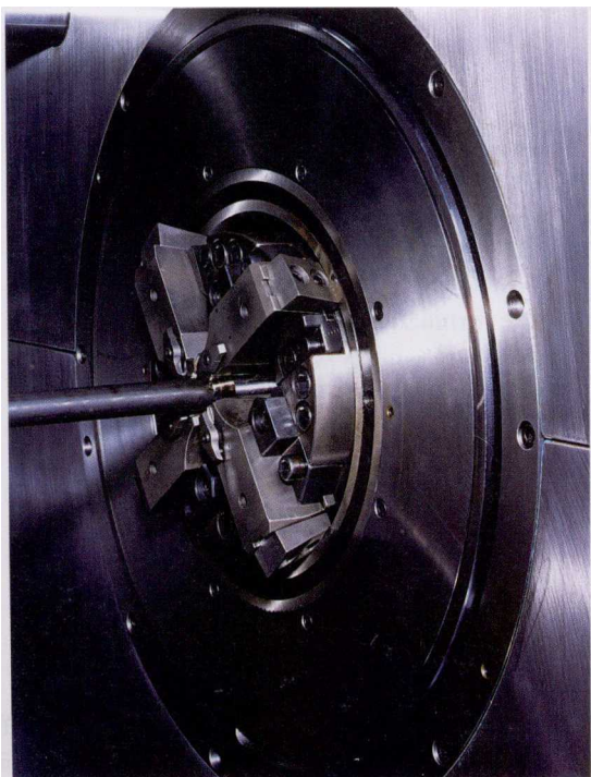
图1 平面车削主要是指采用旋转刀具，在大进给的情况下，对纵向圆车进行动态反转，从而使材料可以得到同心拉拔
