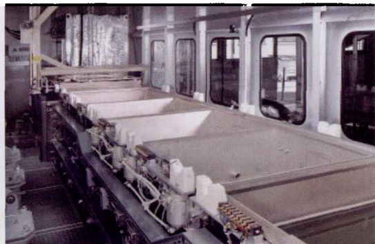
图 2 配备多个清洗槽的 Ecoclean Mega 86W 系统
