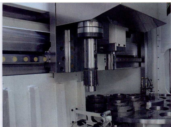
图3 珩磨刀具通过法兰直接对接的定位珩磨主轴
