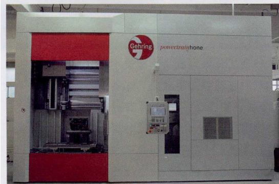
图5 Powertrain 珩磨中心样机
