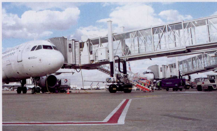
图2 机场登机桥也可采用移动供电方式
