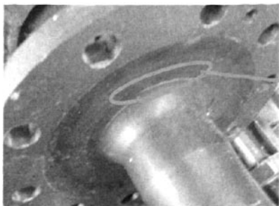
图4 半轴探伤时裂纹状态
