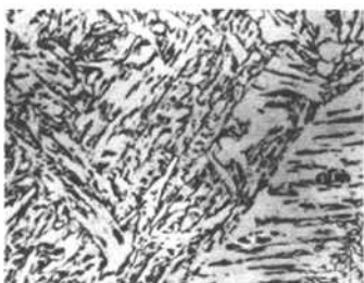
图2 1#试件的HAZ微观组织
