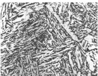
图4 2#试件的HAZ微观组织
