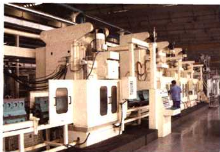
图1 精铣缸体顶面精镗缸孔止口数控自动线
