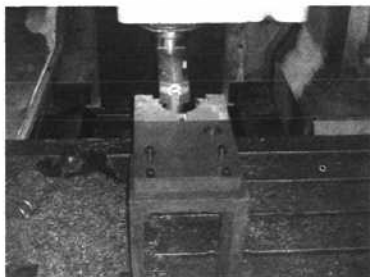
图7 往 Y 正方向移出镗刀
