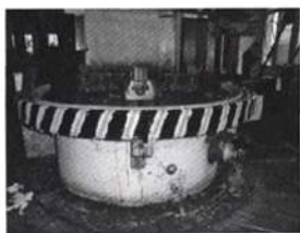
图2 设计防护架后的情况
