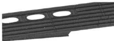
图 1 大型整体带长桁壁板局部详细结构
