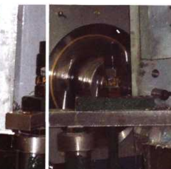
反刮刀通过工件底孔,到达 安全位置
