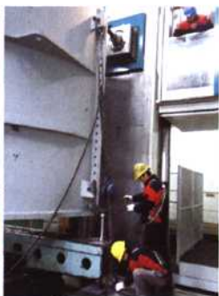
帕莱克反刮刀在3m高孔处 全自动反刮现场
